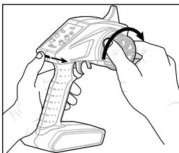
Drehen Sie das Lenkrad voll nach rechts. Halten Sie das Lenkrad in der Position und schalten den Sender ein.
