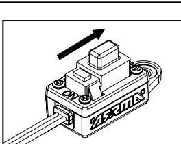
4. Schalten Sie den Regler aus, um das Setup abzuschließen
