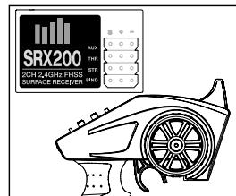
Lassen Sie das Lenkrad los wenn die Empfänger LED aufhört zu blinken.
