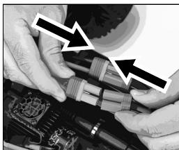
Schließen Sie einen vollständig geladenen Akku an den Regler an.
