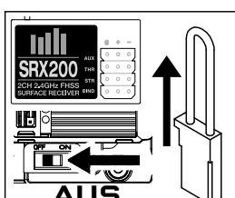
Entfernen Sie den Bindestecker und schalten dann den Empfänger aus um die Einstellungen zu speichern.
