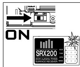
Mettez le contrôleur sous tension. La DEL rouge clignote indiquant que le récepteur est en mode affectation.
